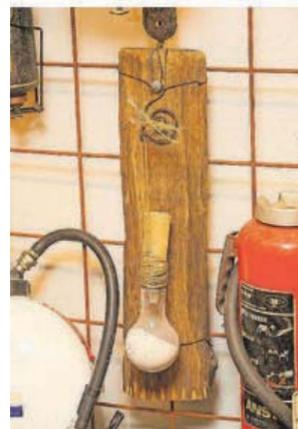
Einer der ersten Feuerlöscher. Die Flammen zerstörten das Seil, und beim Aufprall auf dem Boden gab das Glas das Löschmittel frei.
